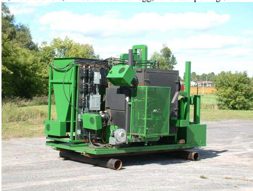
Fig 3:: Mobilt pyrolyse pilotanlegg fra New Energy/Agri-therm.com, [3] (kapasitet 1 t/d)
